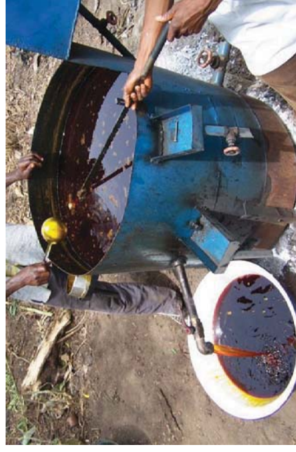
Clarificateur à déverse fixe, nécessite un ajout d'eau pour élever le niveau d'huile Clarificateur type Codéart, équipé d'un transfert d'huile articulé
