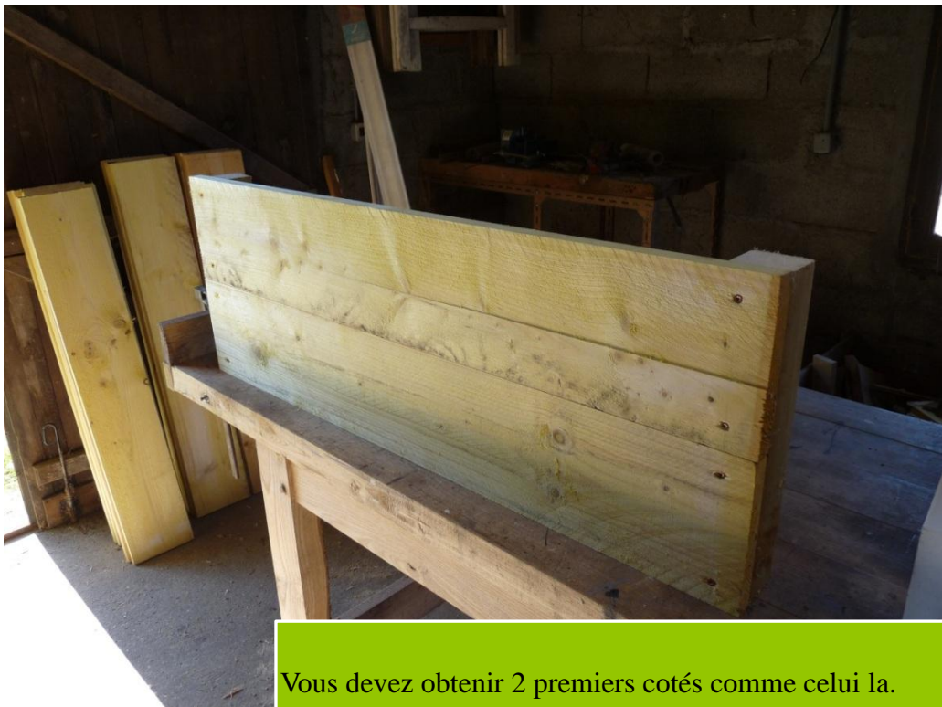
La pièces de bois fixée à l'établi facilite l'assemblage.
