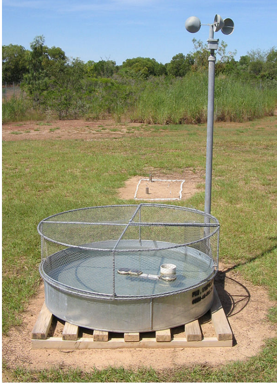
Bac d'évaporation de classe A avec cage de protection et anémomètre
