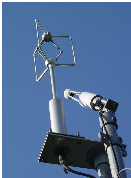
Anémomètre sonique et analyseur infrarouge de gaz pour mesure de covariance des turbulences
