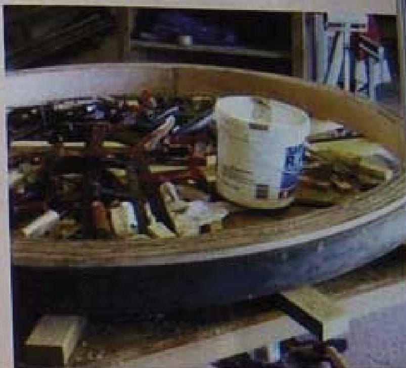
Sur la photo ci-dessus, prise à l'Atelier Bois de Lannemezan, ce ne sont pas des cales qui sont utilisées pour maintenir et former le 'lamellé collé maison', mais un cerclage en fer de la bonne dimension - on pourrait par exemple utiliser le cerclage bien circulaire d'une roue de charrette -. Autre différence sur la photo : le bois utilisé est du contreplaqué.
