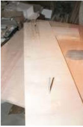
Découpe des arcs à l'aide d'un gabarit et d'une défonceuse.
