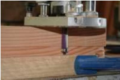
La reproduction du gabarit s'effectue à la défonceuse, avec une fraise à copier : le roulement à billes glisse sur le gabarit (en-dessous) et la fraise taille la pièce au-dessus.
