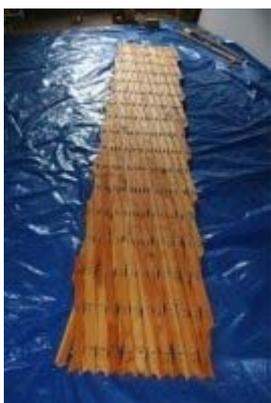
Une fois replié, je pose le mur sur des tréteaux et resserre les boulons un à un. Le degré de serrage est un peu délicat à trouver. Il ne faut pas que les boulons se desserrent (d'où les écrous indesserrables) mais il faut trouver le juste serrage où le mur tient en place ouvert sans s'effondrer et reste relativement aisé à ouvrir et à fermer. Procédez par tâtonnement, en faisant des essais. Le bon serrage est plutôt assez faible.
