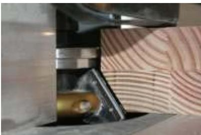
Une dernière découpe inclinée pour la face extérieure du toono qui est penchée pour être à l'angle droit de l'axe d'arrivée des perches.
