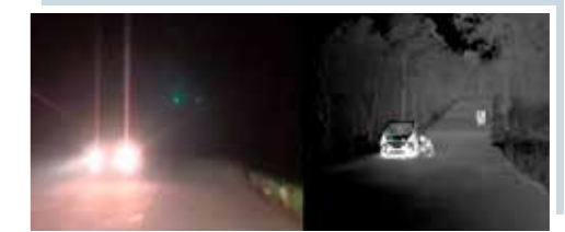
Avec la vision thermique, la caméra ne sera pas éblouie par des lumières telle que des phares de voiture, ce qui permettra d'évaluer correctement la scène.
