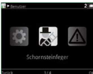
Touche ramonneur pour activer le 2 nd GC pour la mesure des gaz d'échappement
