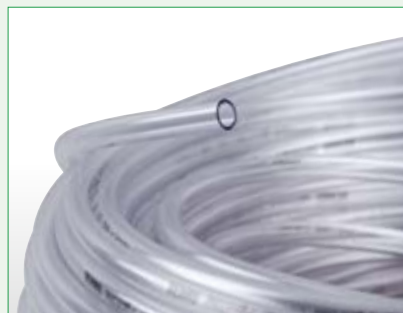
Tuyau de condensat, détaché, 6 mm Ø convient au raccordement aux pompes à condensat KP-8 et KP-6. Longueur max. 20 m pour différence de hauteur de refoulement 10 m.
