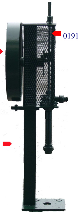
PRINCIPE POMPE PUIITS PROFONDS
