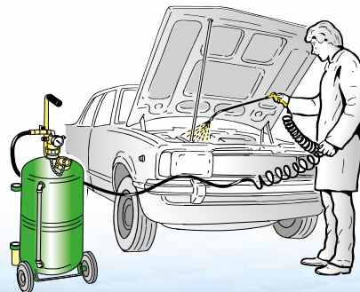
Nébulisation de détergent pour le lavage des moteurs débit du gicleur, environ 1 - 1,5 l/min
