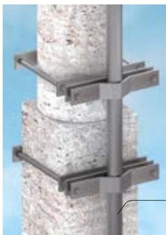
Ancrage pour fixer les mâts de 1" - 1½" à des colonnes carrées ou rondes allant jusqu'à 25 cm. Pour assurer une fixation correcte, les ancrages doivent être séparés entre eux d'au moins 60 cm. Pattes de support individuelles : réf. AT-070B et AT-076B, respectivement.
