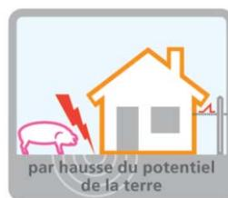
Si la foudre frappe le bâtiment, un paratonnerre, ou la terre à proximité de l'installation, du fait de l'écoulement du courant de foudre dans la terre, un gradient de potentiel va apparaître et les prises de terres proches du point d'impact vont se trouver à des potentiels différents de celui de référence de la terre du neutre. Ces différences de potentiels vont créer des courants de rééquilibrage dans les lignes reliant ces installations.
