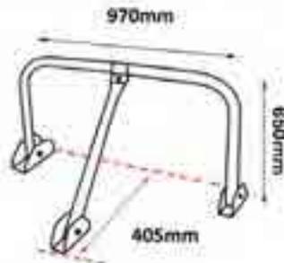
Fixations pour sol béton incluses
