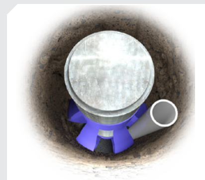
Coupe du tirant en longueur scellée avec un tube d'injection
