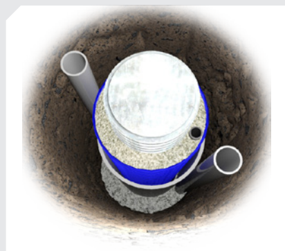
Coupe du tirant en longueur libre avec un tube d'injection
