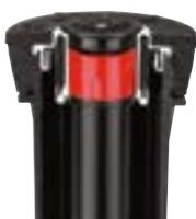
Le joint racleur le plus robuste du secteur est co-moulé à partir de deux types de matériaux résistant aux produits chimiques et au chlore. Ce joint racleur multifonctions activé par pression assure un fonctionnement sûr à basse pression et permet l'installation de plusieurs arroseurs dans la même zone. Sa conception innovante empêche les débris de pénétrer le joint quand le piston est rétracté, ce qui réduit les "collages" du piston.
