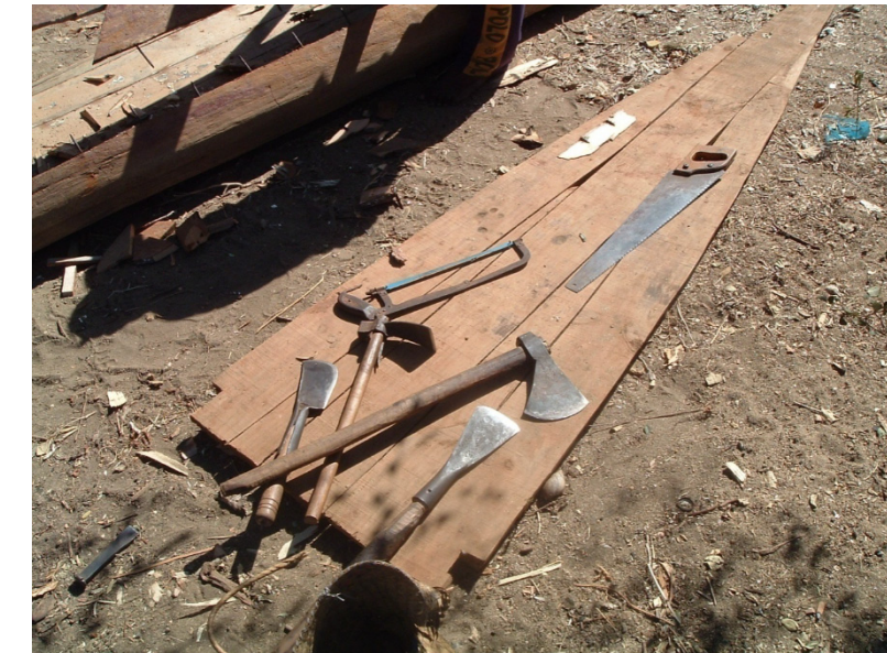
L'outillage de base des charpentiers de navire pour la construction d'une pirogue à balancier (manquent la chignole à main et le marteau), in « Photographie 69 : L'outillage de base des charpentier », Eddy Renoux, ibid, page 224 [9].
