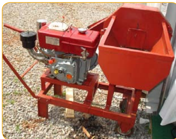
▲ Cette machine à casser les noix permet aux agriculteurs de transformer bien plus facilement les durs pignons de njansang.
